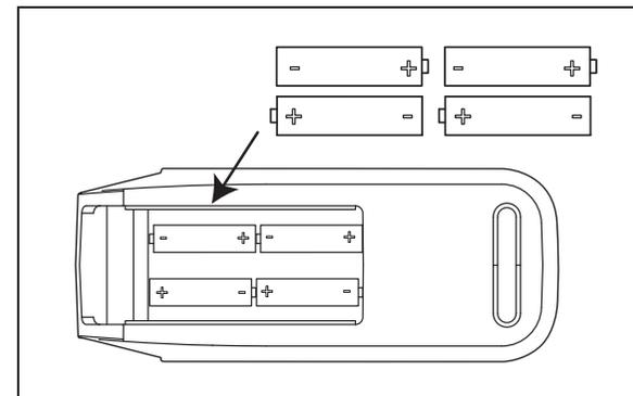
1. Ouvrez le compartiment à batterie à l'arrière de l'agrafeuse.
